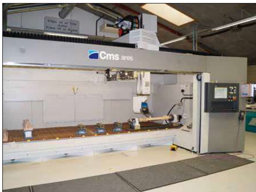
Den nye CNC er en CMS Ares 4818 med seks akser. Udover fem-akset bearbejdning kan emnet sættes op i et rundbord og bearbejdes i nøjagtige positioner.
