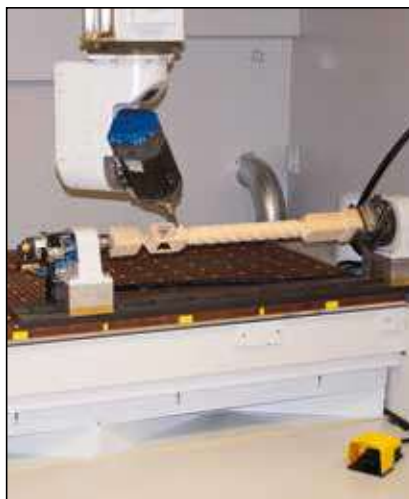
Rastebordet er forsynet med et antal sugeskopper, der passer ned i de spor, som er fræset i bordet.
