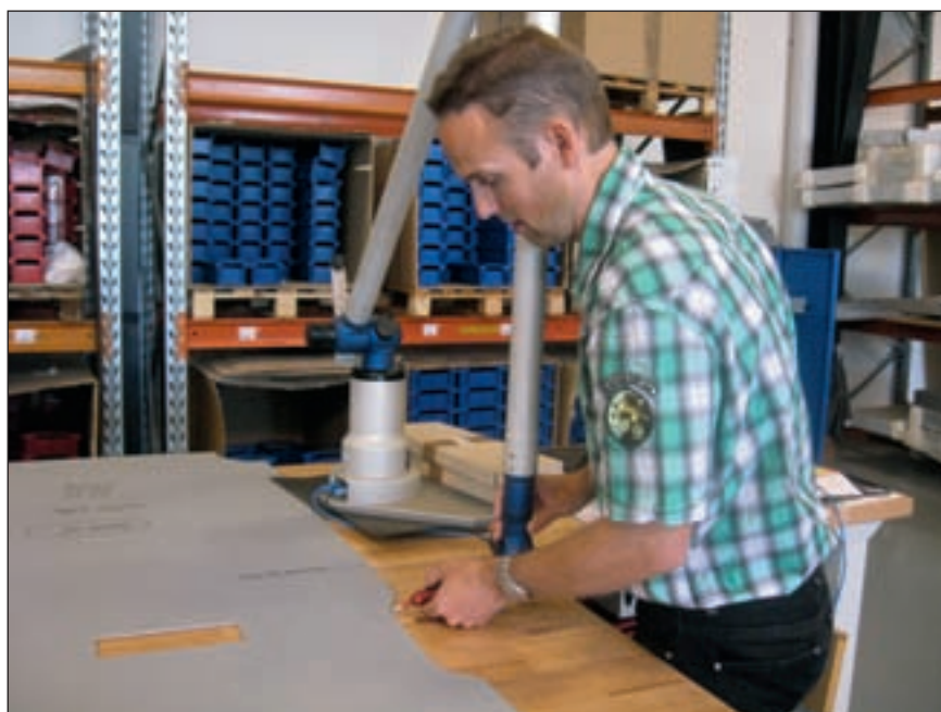
Med digitizeren overføres udmålingsdata automatisk til CAD/CAM. Der udmåles direkte i bilens lastrum eller som her, hvor Jan Dupont opmåler en eksisterende skabelon.
