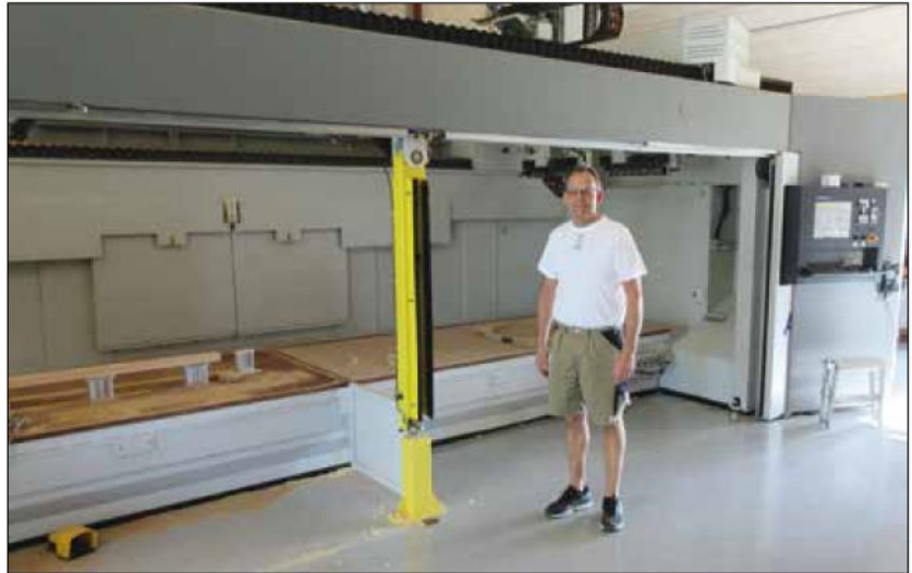
Op til seks meter lange emner kan lægges direkte ind i maskinen med gaffeltruck.
