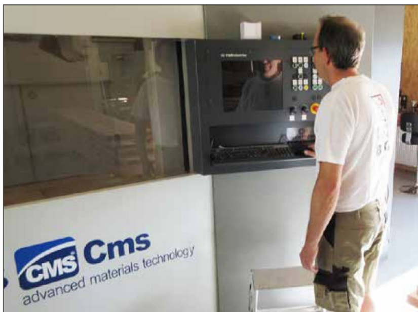
Al programmering udføres i AlphaCAM, hvor den maskinspecifikke postprocessor fremstiller NC-filerne.
