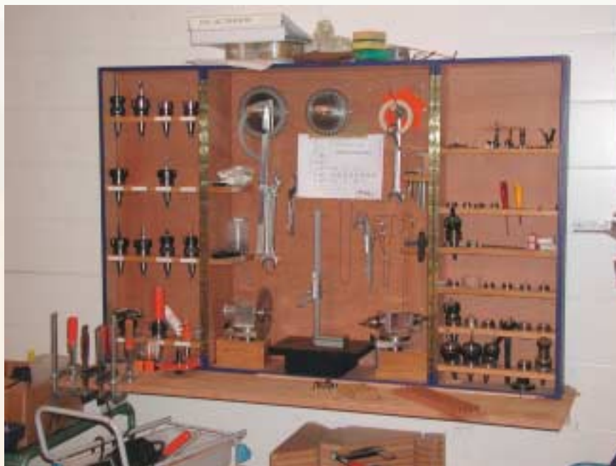
I værktøjsskabet står værktøjerne i hver sin holder, da det vil tage for lang tid at skifte eksempelvis små bor ud. Det betyder i praksis, at når der indkøbes en ny type værktøj, så købes der en værktøjsholder sammen med.
