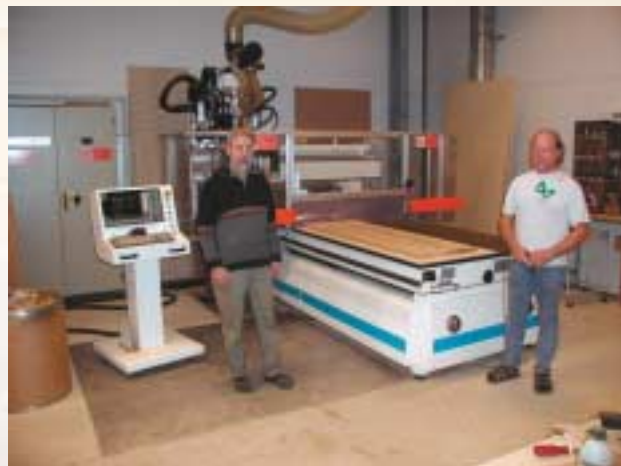
Carsten Lund (tv) og Klavs Olesen ved den 4-aksede Bulleri CNC maskine, der klarer horisontale og vertikale bearbejdnings på både små og store emner.
