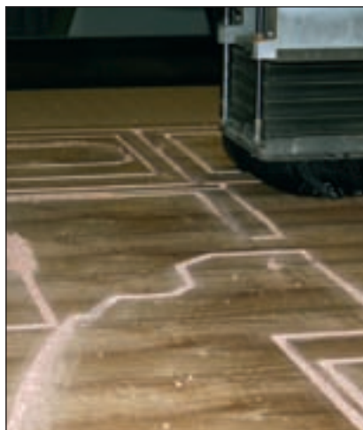
Plade er lagt på vakuumbordet og fræsningen igangsæt.
