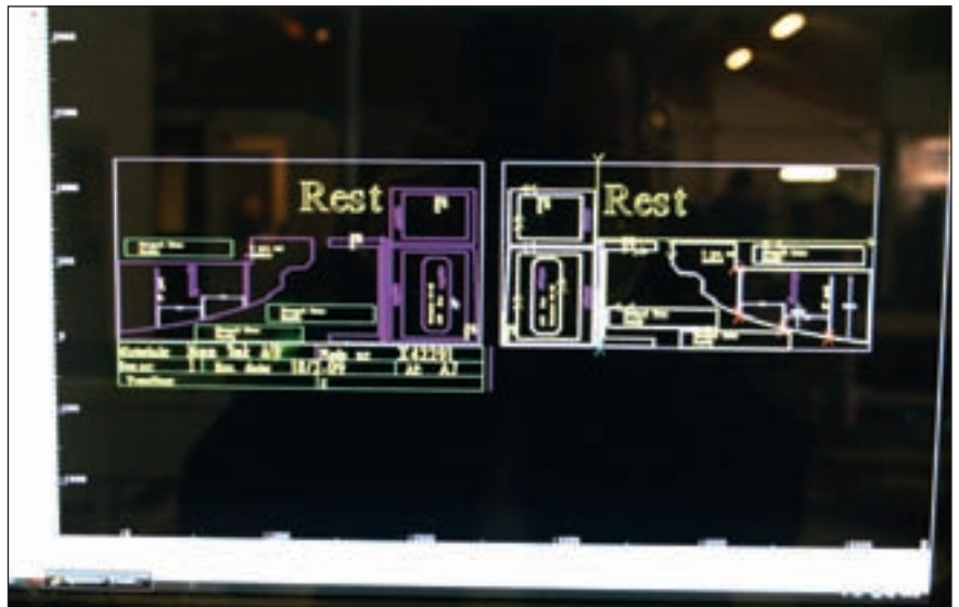
Et typisk oplæg af emner på plade til nesting. Der kan foretages simulering inden fræsning.
