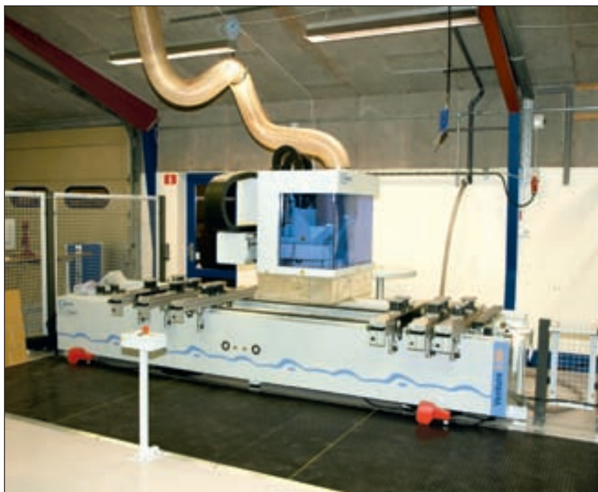
Den nyeste maskine er en Weeke Venture 2,5, der ligner mange brugeres maskiner med hovedspindel, borekasse med notklinge samt vinkelgear for bearbejdning i vilkårlige planer.
