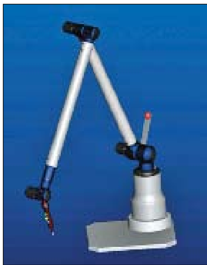
Digitizeren Baces har et arbejdsområde op til 3200 eller 4200 mm med tolerancer ned til ±0,15 mm.
