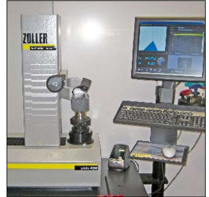
For at sætte ekstra fokus på værktøjerne er der investeret i en Zoller værktøjsopmåler.
