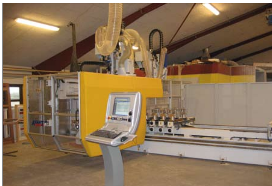
Virksomheden kan nu producere vinduer fra omkring 20 cm i bredden og op til flere meter på samme maskine.
