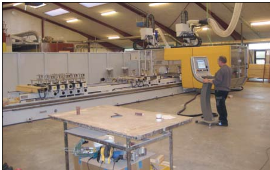
CNC-maskinen er af typen med en langsløbende portal, et arbejdsområde på 7400 x 1600 mm og med specialdesignede clamps, som vinduesproducenten selv var med til at konstruere.
