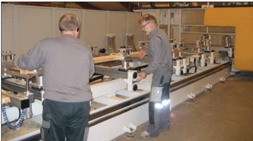
Alle emner i en givet ordre færdiggøres fuldstændig som tegninger, og ud fra en prioriteringsliste optimeres disse tegninger ud over hele maskinens bord, hvor der er otte oplægningspladser.
