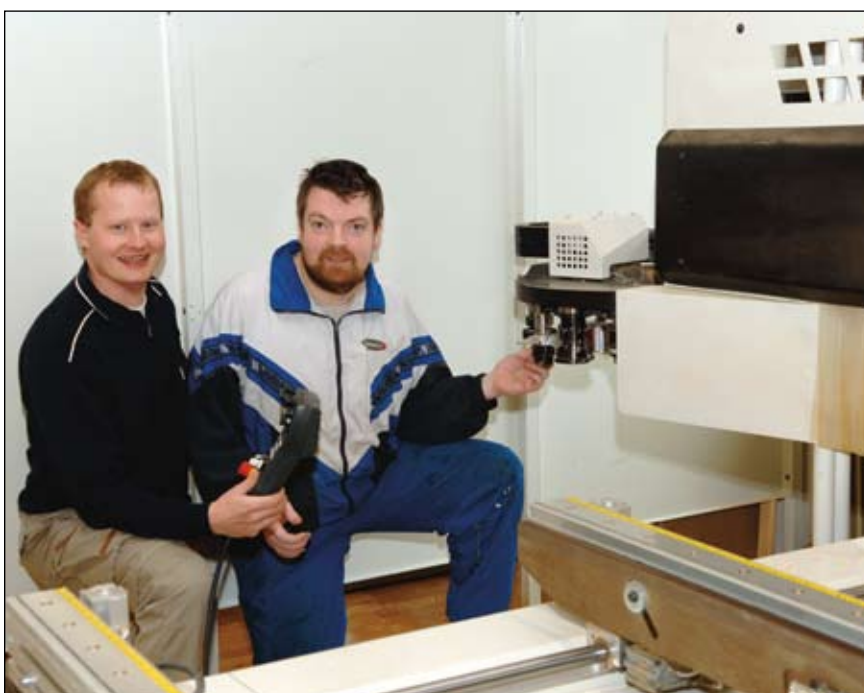
Jan Damgaard og Paw Nydag Nielsen tjekker, at det er de rigtige værktøjer, der sidder i værktøjsveksleren, hvor der er plads til 12 værktøjer.
