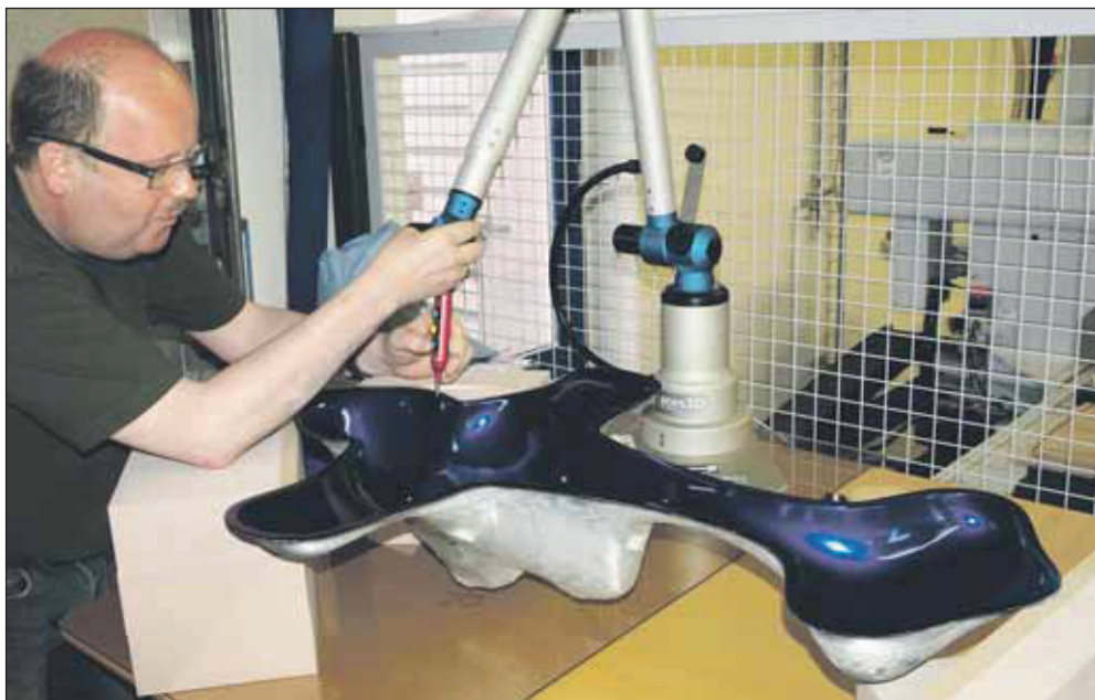
ØCC råder over en digitizer til opmåling af emner. Emnets dimensioner lægges direkte ind i Alphacam. En del kunder benytter disse til forskellige opmålinger som eksempelvis indretning af varevogne, møbeldele og båadaptorer.
