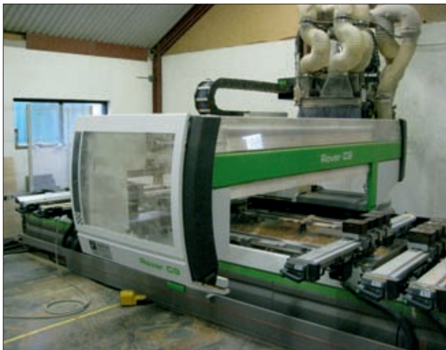
Den 5-aksede teknologi og CAD-CAM har givet inventarsnedkeriet mange muligheder for løsning af specialopgaver.
