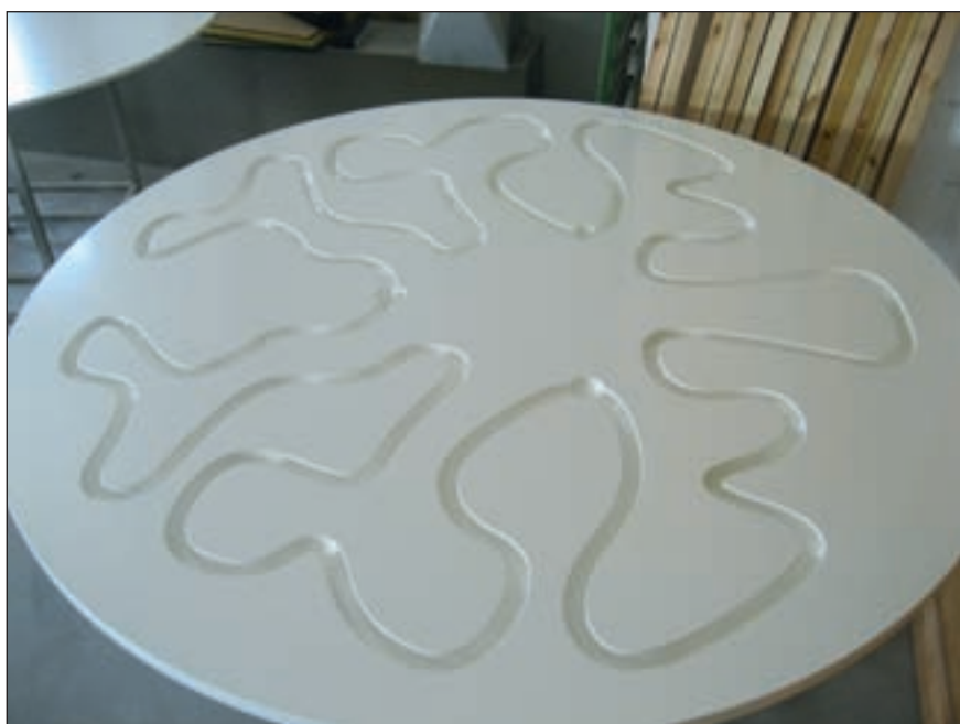
Fræseopgave udført for Experimentariet. Arkitekten leverede en CAD-tegning, resten blev klaret i AlphaCam.
