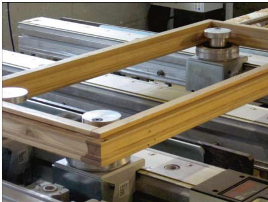
AlphaCam på CNC-maskinen betyder, at der blot skal indtastes bredde og højde på emnet, så klarer maskinen resten.
