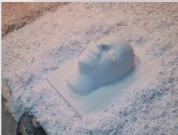
Det færdige resultat bekræfter, at der kan bearbejdes overflader i alle vinkler fra vandret til lodret.
