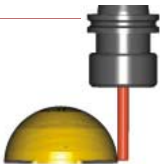
Denne kugle bearbejdes med et afrundet værktøj. Her er der kun »udvendige radier«, så der er ingen grund til at efterbearbejde med en kuglefræser.
